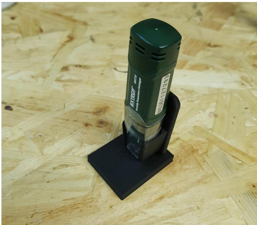
Mjerni instrumenti su takvi da ne smetaju normalnom životu ukućana te su ne veći od 15 x 4 x 3 cm, mase manje od 50 grama uključujući bateriju. Mjereni uređaj imaju mogućnost paralelnog mjerjenja temperature i vlage u minutnom zapisu kako bi se mogli prikupiti svi podaci o karakterističnim događajima (otvaranja prozora, kuhanje, tuširanje i dr.)
